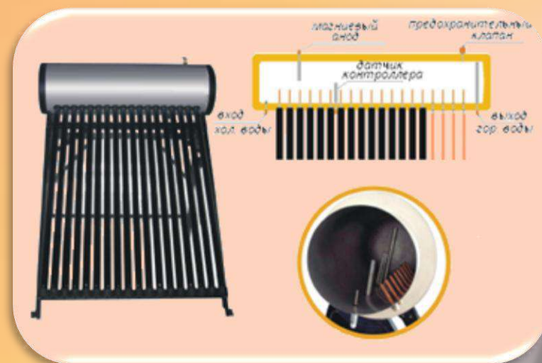
Схема компактного солнечного водонагревателя под давлением
